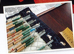
丸キリ 小さな丸は、 その大きさに あった丸キリ (丸鋸)と呼ぶ 道具を使います。
